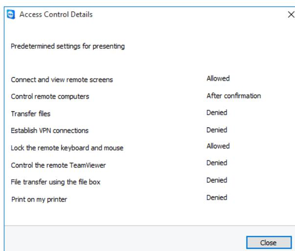
Après que la connexion est établie, une boîte de dialogue est affichée pour indiquer les différences entre les paramètres de contrôle d'accès sortant sur l'ordinateur local et les paramètres de contrôle d'accès entrant sur l'ordinateur distant.
